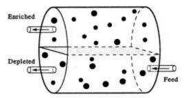
Fig. 9.3 Gaseous diffusion stage.
