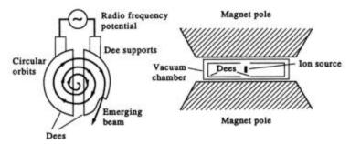
Fig. 8.7 Cyclotron.
