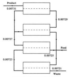
Fig. 9.4 Gaseous diffusion cascade.
